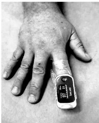
Рис. 1. Способ использования пульсоксиметра при измерении с изоляцией кожи пальца полиэтиленовой пленкой
