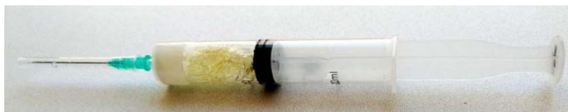
Рис. 1. Экспериментальная шприц-колонка с хитозаном
