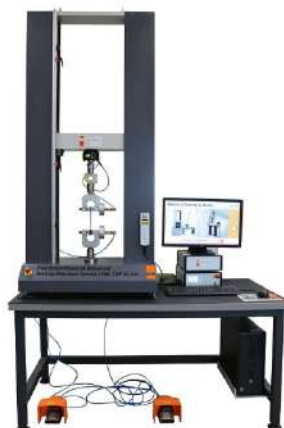
Рис. 1 Электромеханическая настольная машина LFM-50 kN
