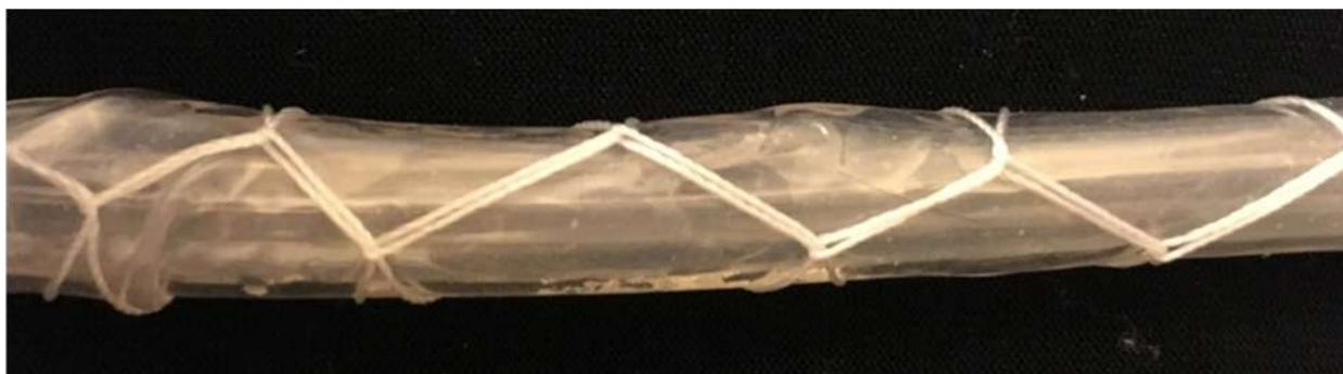
Рис. 2. Схема плетения фиксирующей нити
