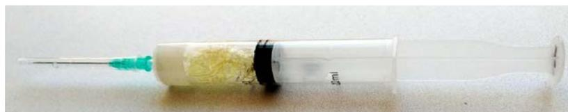
Рис. 1. Экспериментальная шприц-колонка с хитозаном
